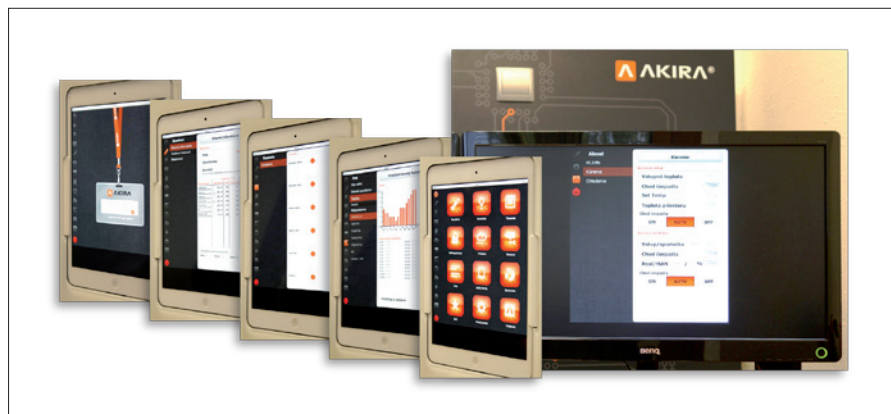
Obr. 2. Slovenský systém Domotron je postaven na Foxtrotu – uživatelsky zpracovaná grafika včetně logiky ovládání i stránky přihlašovacího dialogu jsou plně dílem programátorů integrátorů systémů, firmy Akira
