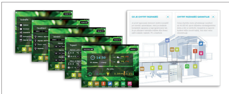
Obr. 3. K chytrému rozváděči české firmy Suptechnik stačí pouze připojit externí instalaci; vše je završeno vlastní grafikou a ovládáním na bázi webových stránek systému Foxtrot
