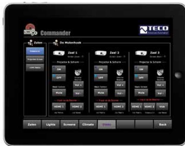
V kongresovém hotelu Van Der Valk Hotel Veenendaal v Holandsku svěřili Foxtrotu řízení osvětlení, zastínění, klimatu, projekčních pláten, audia a videa v patnácti sálech, které se dají operativně slučovat v návaznosti na rezervační systém hotelu. Vše je ovládáno tablety přes webový server Foxtrotu.
